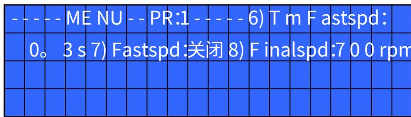
7) Fast spd (Fast Speed):表示螺丝刀在切换到“预设速度”（较低速度）之前应以 FAST SPEED 速度（见第 8 点）转动多长时间。“预设速度”是在第 6 点设置的速度。此 FAST SPEED 时间可设置为 0.3 至 10.0 秒。
